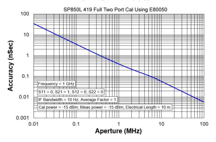
一般情况下,下列公式可以很快确定具体群时延测量中的精确度: 土相位精度(deg)/[360 ×孔径(Hz)] 因为器件长度和孔径的不同,使用的相位精度可能是增益值的相位精确度,也可能是最坏情况下的相位精度。
